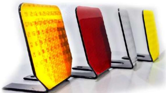
Sinalizador de barreira metálica são delineadores fabricados em chapa de aço galvanizado a fogo, bitola nº 14, revestidos com películas retrorrefletivas Al de Alta Intensidade conforme as normas da ABNT. Com formato retangular, dimensões do refletivo de 80 x 75 mm e abas de fixação de 80 x 45 mm, apresentam peso médio de 120 g. O detalhamento das abas está disponível em desenho técnico. Utilizam películas retrorrefletivas apenas na frente e atendem às normas da ABNT.
