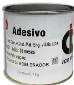
Adesivo bicomponente, recomendado para dispositivos injetados de ABS, possui uma apresentação em latas de 1kg. Com tempo de secagem em torno de 15 minutos, é crucial evitar movimentação durante esse período para garantir a eficácia do endurecimento. Após o mesmo intervalo de 15 minutos, o local estará pronto para o tráfego, assegurando a liberação adequada para a circulação de veículos.
