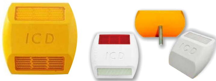
Tachas para sinalização são dispositivos produzidos em resina de alta resistência resistindo ao tráfego constante de veículos, são acompanhadas de um pino com rosca na parte inferior da peça com o propósito de fixação juntamente com a adesivo utilizado para fixação.
