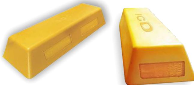
Este dispositivo, fabricado com resina de poliéster ou material sintético na cor amarelo âmbar, destaca-se pela sua elevada resistência mecânica. Possui pinos externos zincados com rosca ancoradora, apresentando dimensões de 490 x 160 x 80 mm e um design linear. Oferece a flexibilidade de incluir elementos refletivos nas laterais (130 x 30 mm) e/ou nas pontas (100 x 30 mm), podendo também ser adquirido sem elementos refletivos.
