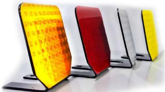
Sinalizador de barreira metálica são delineadores fabricados em chapa de aço galvanizado a fogo, bitola nº 14, revestidos com películas refletivas Al de Alta Intensidade conforme as normas da ABNT. Com formato retangular, dimensões do refletivo de 80 x 75 mm e abas de fixação de 80 x 45 mm, apresentam peso médio de 120 g. O detalhamento das abas está disponível em desenho técnico. Utilizam películas retrorrefletivas apenas na frente. Produto de acordo com as normas ABNT.
