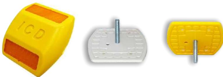
A tacha retrorrefletiva com bi-injeção de plástico ABS, proporciona grande capacidade de resistência mecânica e abrasiva, tornando um produto com alta durabilidade. Seu pino externo, com rosca ancorada e zincado, quando fixado junto ao adesivo, garante uma melhor fixação da peça no solo.
