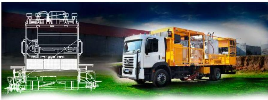
Máquina para aplicação de termoplásticos nos sistemas Hot Spray e Extrudado desenvolvida para realizar a fusão e aplicação de materiais utilizados na demarcação viária com alta eficiência e precisão. Ideal para faixas simples, tracejadas, duplas e legendas de trânsito, o equipamento é projetado para operar em condições severas, garantindo longa durabilidade e alto desempenho, mesmo em áreas de tráfego intenso.
