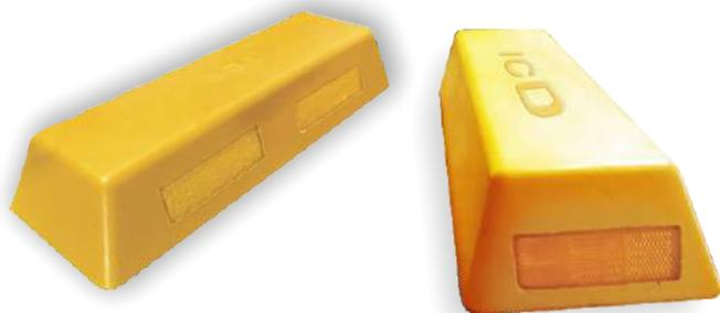
Este dispositivo, fabricado com resina de poliéster ou material sintético na cor amarelo âmbar, destaca-se pela sua elevada resistência mecânica. Possui pinos externos zincados com rosca ancoradora, apresentando dimensões de 490 x 160 x 80 mm e um design linear.
