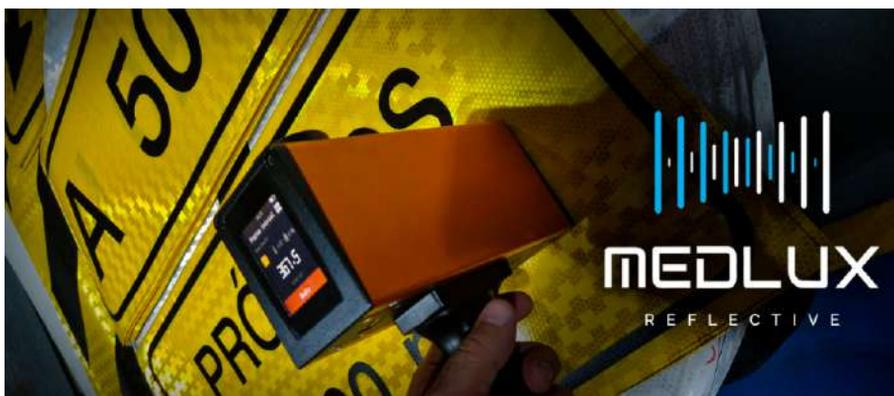
O retrorrefletômetro MEDLUX, é um equipamento projetado para medir o coeficiente de retrorrefletância em películas utilizadas em sinais viários. Sua versatilidade permite sua utilização tanto em ambientes laboratoriais quanto em medições em campo.
