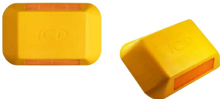
Tachão retrorefletivo para sinalização (tartaruga) da marca ICDVIAS.com.br, é de alta durabilidade por resistir a altas cargas de compressão. O dispositivo possui dois pinos de aço galvanizado para fixação, e deve ser aplicado juntamente com o adesivo para dispositivos de resina.
