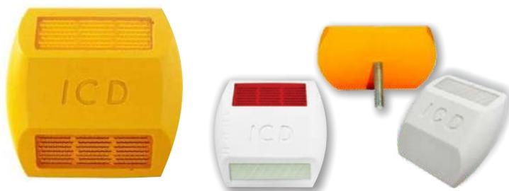
Tachas para sinalização são dispositivos produzidos em resina de alta resistência resistindo ao tráfego constante de veículos, são acompanhadas de um pino com rosca na parte inferior da peça com o propósito de fixação juntamente com a adesivo utilizado para fixação.
