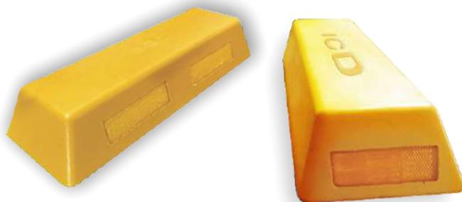
Este dispositivo, fabricado com resina de poliéster ou material sintético na cor amarelo âmbar, destaca-se pela sua elevada resistência mecânica. Possui pinos externos zincados com rosca ancoradora, apresentando dimensões de 490 x 160 x 80 mm e um design linear. Oferece a flexibilidade de incluir elementos refletivos nas laterais (130 x 30 mm) e/ou nas pontas (100 x 30 mm), podendo também ser adquirido sem elementos refletivos.
