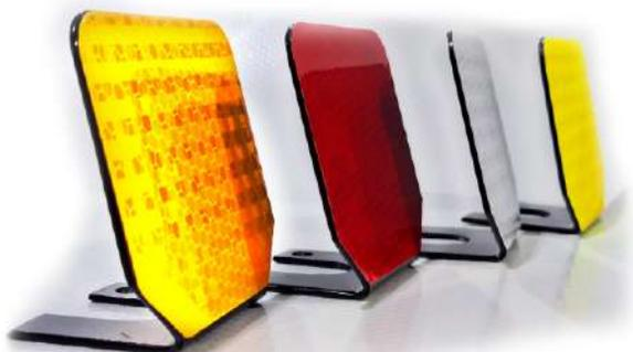
Sinalizador de barreira metálica são delineadores fabricados em chapa de aço galvanizado a fogo, bitola nº 14, revestidos com películas refletivas Al de Alta Intensidade conforme as normas da ABNT. Com formato retangular, dimensões do refletivo de 80 x 75 mm e abas de fixação de 80 x 45 mm, apresentam peso médio de 120 g. O detalhamento das abas está disponível em desenho técnico. Utilizam películas retrorefletivas apenas na frente e atendem às normas da ABNT.
