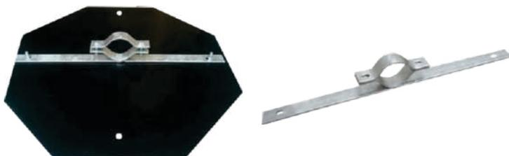
A abraçadeira tem a função de manter a placa fixa ao poste, evitando que ela se desloque com o vento. Produzida em aço galvanizado a fogo, o que a torna resistente às condições climáticas adversas.
